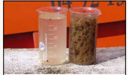
Lodos para contenedor Geotube® en lechos de secado en estación municipal de tratamiento de aguas.
