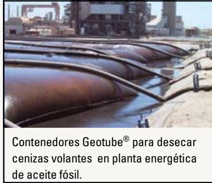
Contenedores Geotube® para desecar cenizas volantes en planta energética de aceite fósil.
