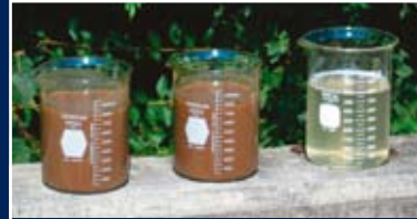
Lodos antes y después del tratamiento con la Tecnología para desecado Geotube®.
