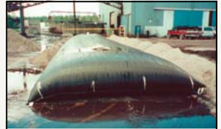
Desecado de lodos de carbón usando la Tecnología de desecado Geotube®.
