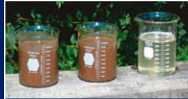
Lamas antes e depois do tratamento com a tecnologia de desidratação Geotube®
