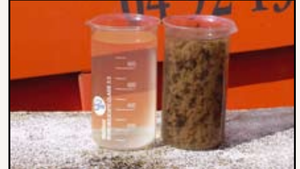
A gauche, l'effluent après filtration par la technologie GEOTUBE®. A droite, la boue flocculée.
