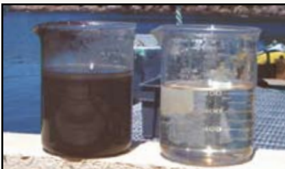
Eau de fond de bassin d'aquaculture avant et après le traitement par la technologie GEOTUBE®.
