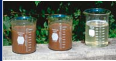
Les boues avant et après le traitement avec la technologie d'essorage GEOTUBE®.
